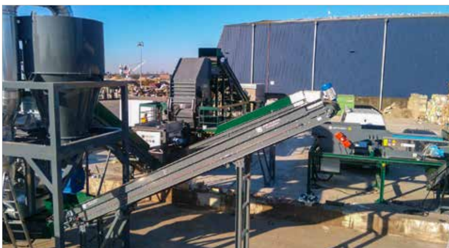
Recycling plant with FLEX 1300, Zig-Zag separation and eddy current ECP 1000 Impianto riciclaggio con FLEX 1300, separazione Zig-Zag e correnti parassite ECP 1000
